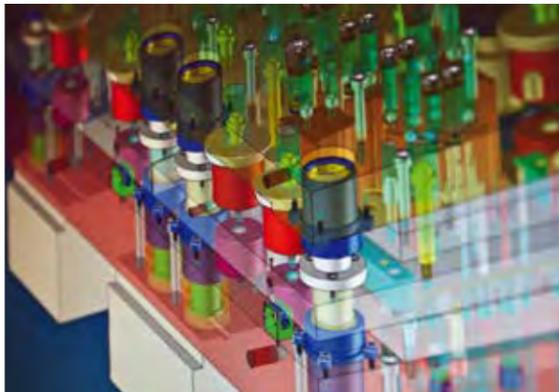
Fase di progetto CAD/CAM in 3D del GalvaninLab e stampo realizzato dall'officina interna Galvanin S.p.a.
