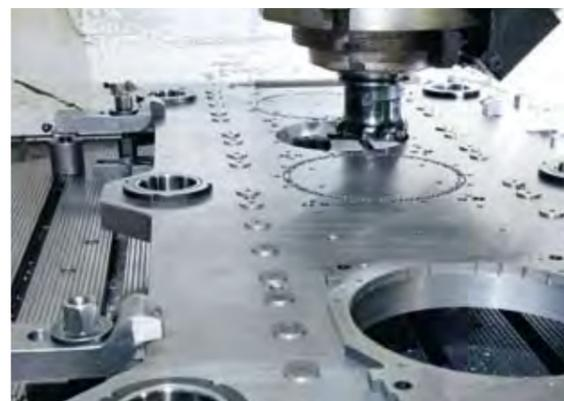
Fresatura su una piastra di estrazione delle cave per i vari componenti dello stampo
