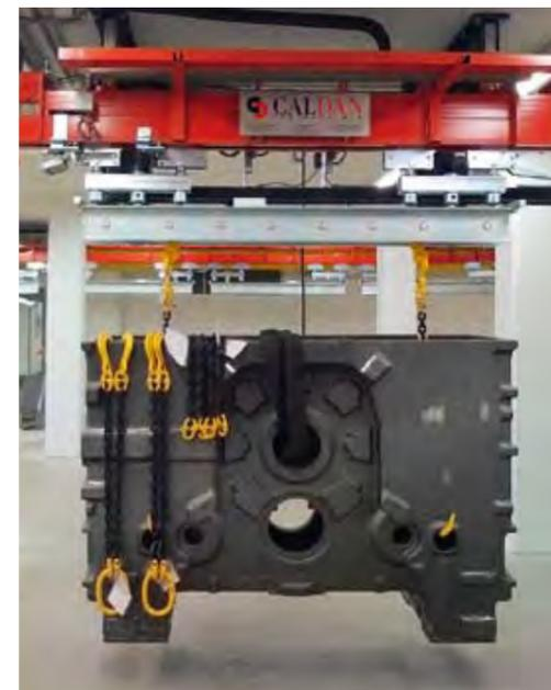
Robuste rotaie trasportano lungo l'impianto di verniciatura pezzi fino a 2,5 ton.
