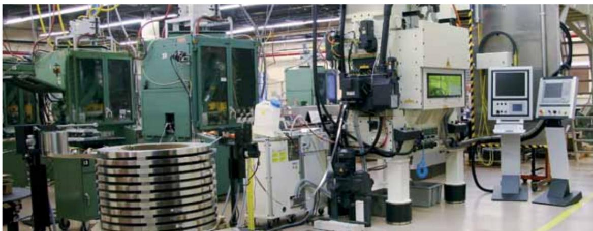
Tranciatura e saldatura laser sotto pressa
