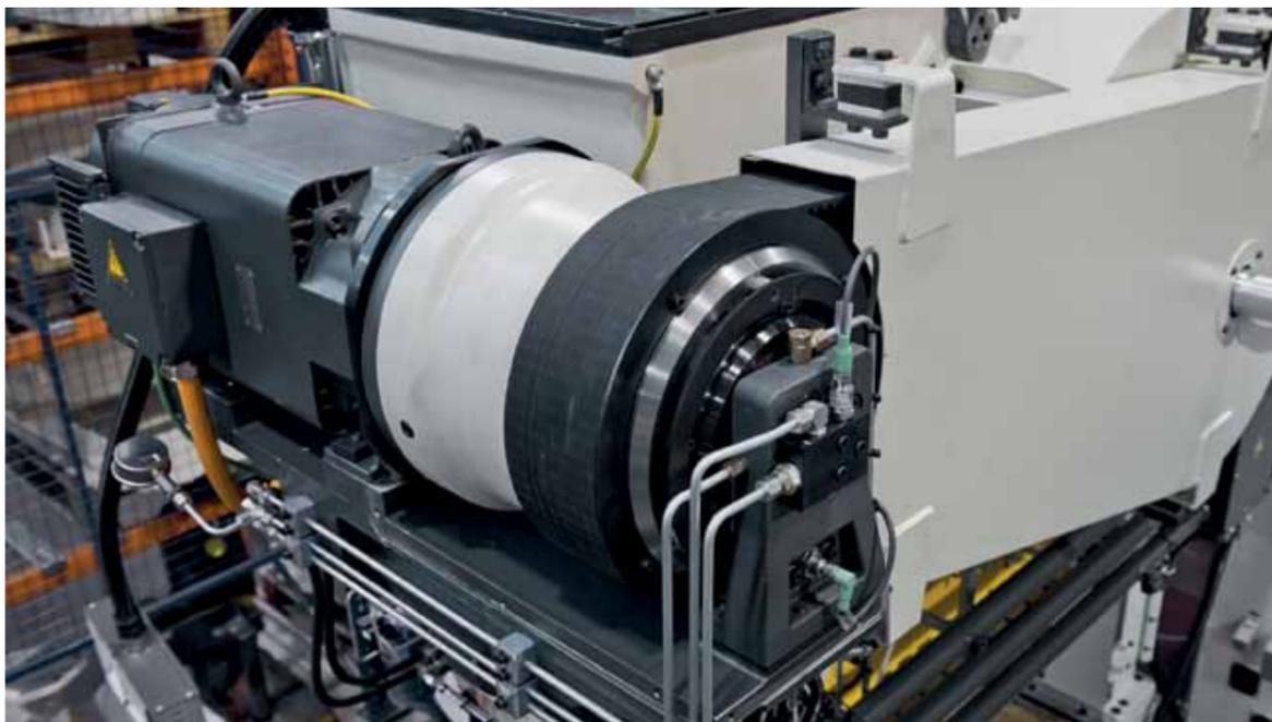
Riduttore epicicloidale montato sul motore principale con tutte le connessioni
