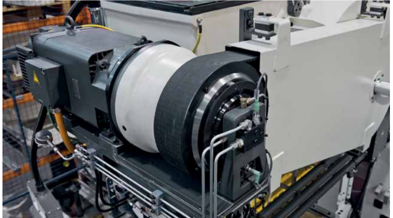
Un entraînement épicycloïdal monté sur le moteur principal avec tous les tuyaux de connexion
