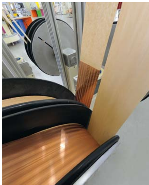
Avvolgimento automatico del coil.
