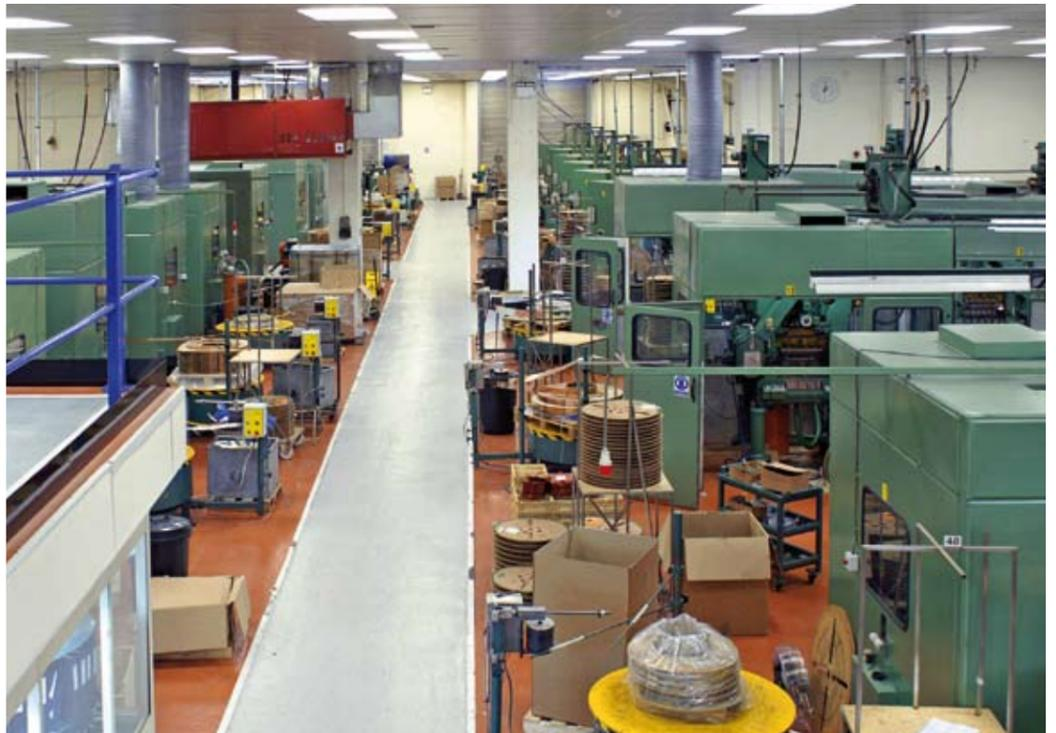
Produzione di Batten & Allen a Cirencester: 24 trance di Bruderer dove vengono impiegati stampi di costruzione propria. Un collaboratore ogni 8 trance si occupa delle verifiche a campione.
