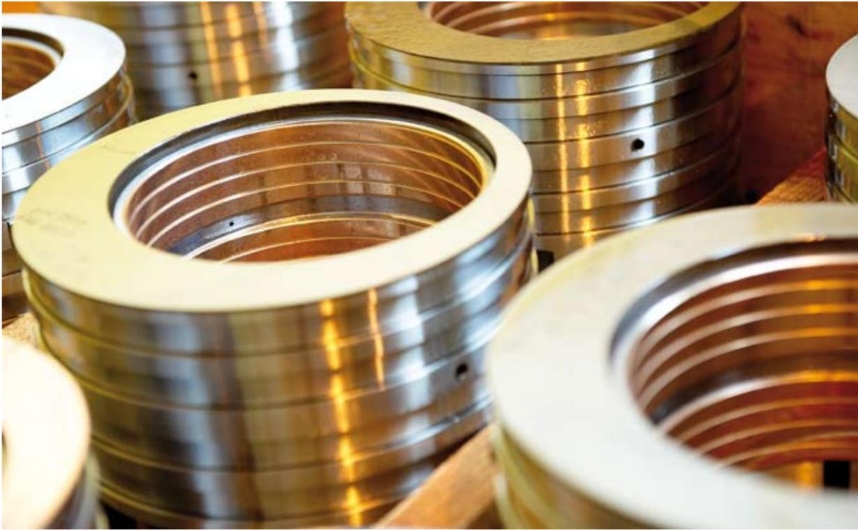
La qualità, Bruderer sempre al massimo. Esempio: la finitura delle superfici di scorrimento dei cuscinetti dove viene controllato il livello di rugosità superficiale, inferiore al micron (<0,001 mm.).
