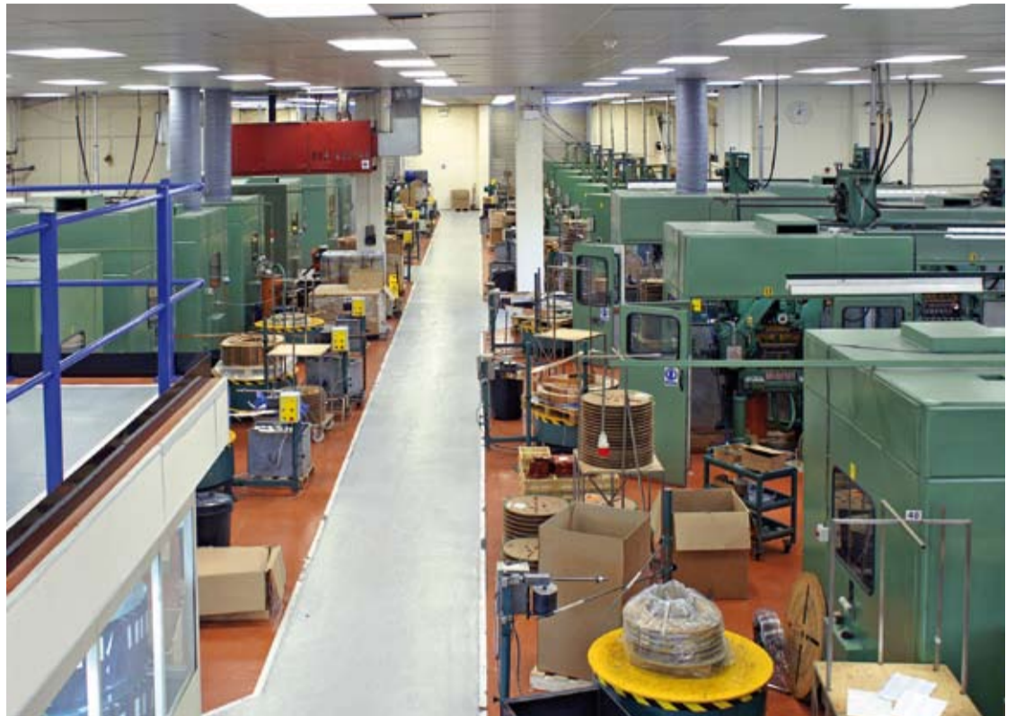
La production chez Batten & Allen à Cirencester: les 24 presses automatiques à découper à grande vitesse sont essentiellement équipées d'outils et moules de fabrication maison. Un employé sur huit procède à des tests sur une base d'échantillons aléatoires.
