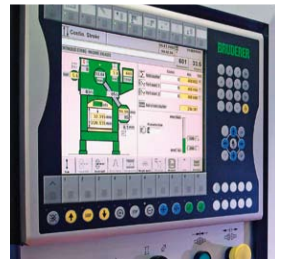
L'écran de contrôle sur une presse à découper automatique Bruderer: clair, facile à lire et convivial.
