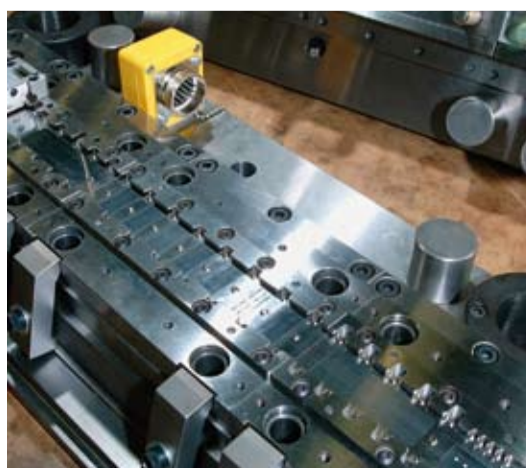
Un outil à multistations et multitâches utilisé chez Batten & Allen sur les presses à découper automatiques Bruderer.
