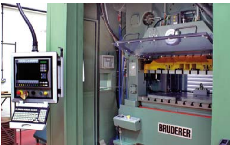
La dernière presse à découper installée à Cirencester est une machine avec espace de montage long de la série BSTA 300-85B.
