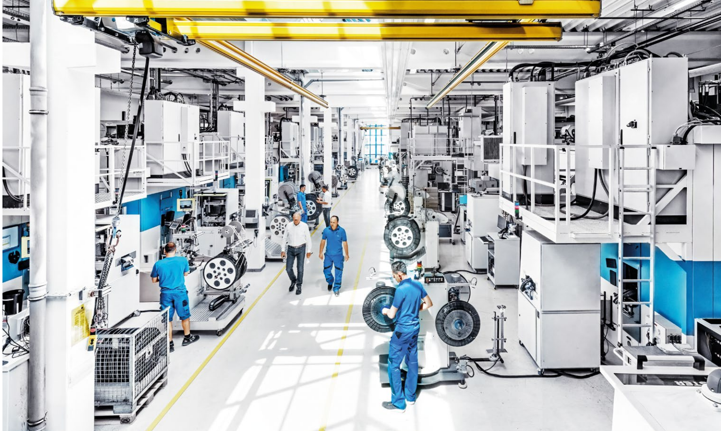
BRUDERERの25~80tonのプレス機を22台設置したスタンピング部門
