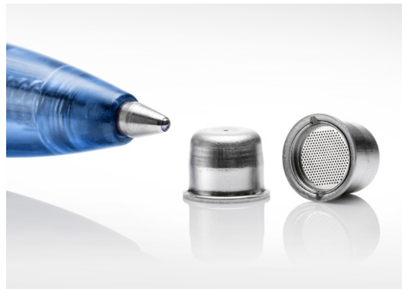
Ziehteil mit Filter. Zuführung von 2 Bänder: Metallfilter und Grundmaterial für Blende plus Laserschweissprozess.
