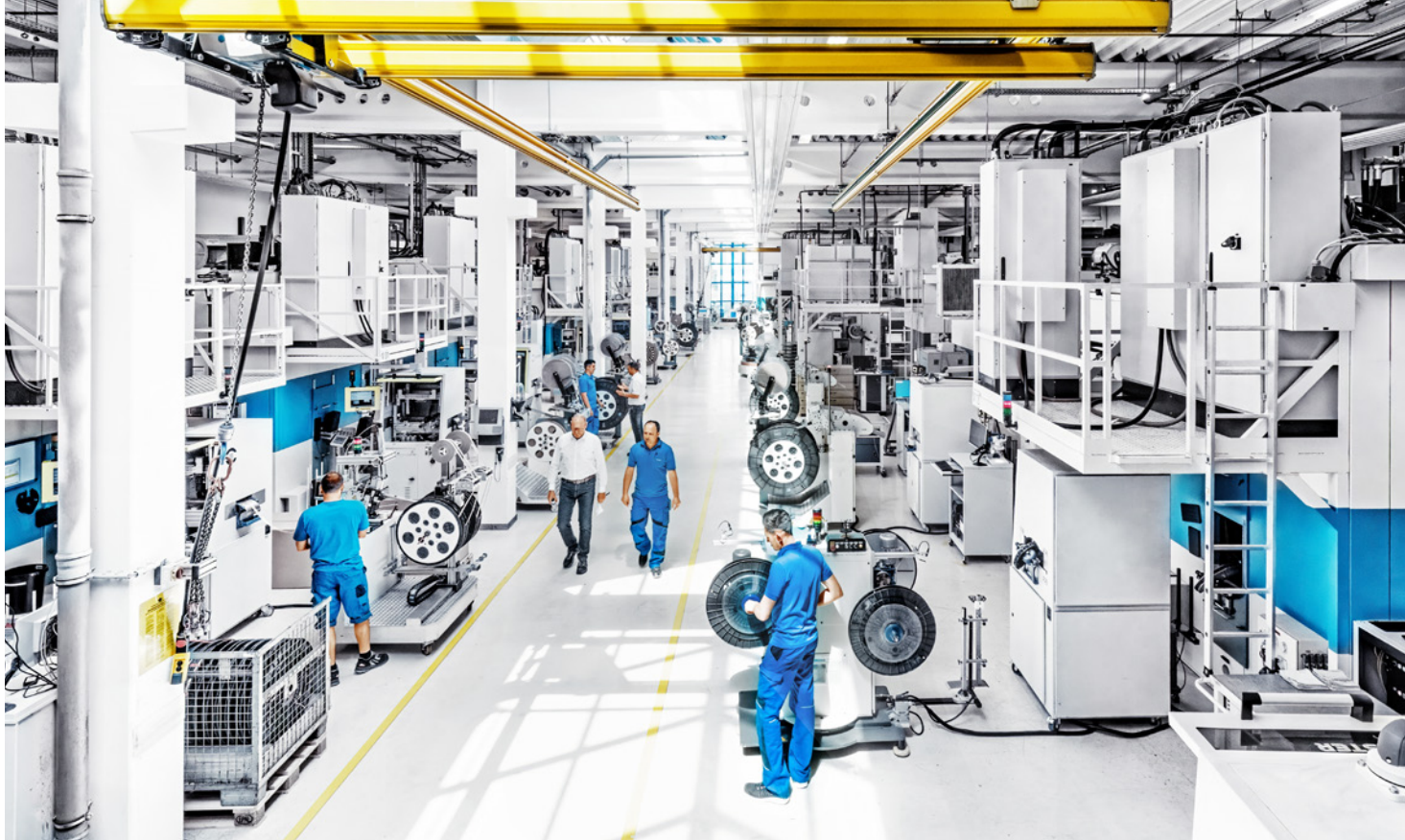
Blick in die Stanzerei mit 22 BRUDERER Maschinen von 25–80 Tonnen.
