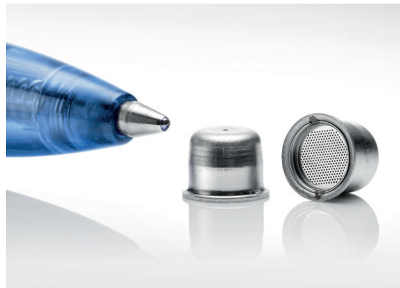
带有过滤网的拉伸零件。同时送入两根料带：金属滤网和冲压壳体的原材料料带，再加上激光焊接。
