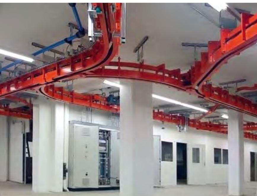
Mit Hilfe von RFID-Daten werden die Werkstücke auftragspezifisch durch die Anlage geleitet und bearbeitet.
