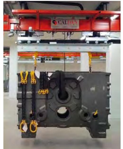
Auf massiven Schienen werden Teile bis 2,5 Tonnen Gewicht durch die Nasslackieranlage befördert.
