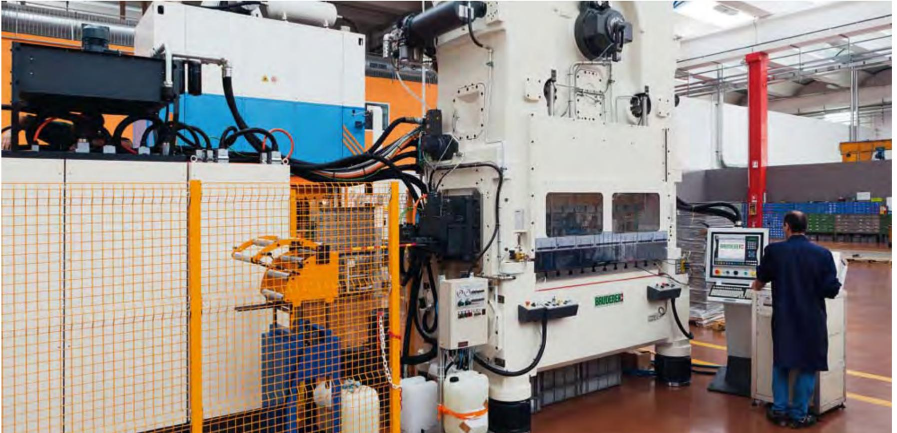
Der neue BSTA 1600-181B aus dem Hause Bruderer wird bei Galvanin S.p.a. eingefahren.
