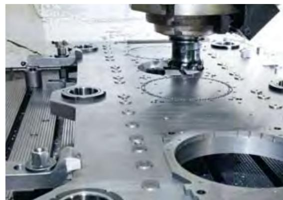
Bei einer Abstreifplatte werden die Aussparungen für die verschiedenen Elemente des Werkzeuges ausgefräst.
