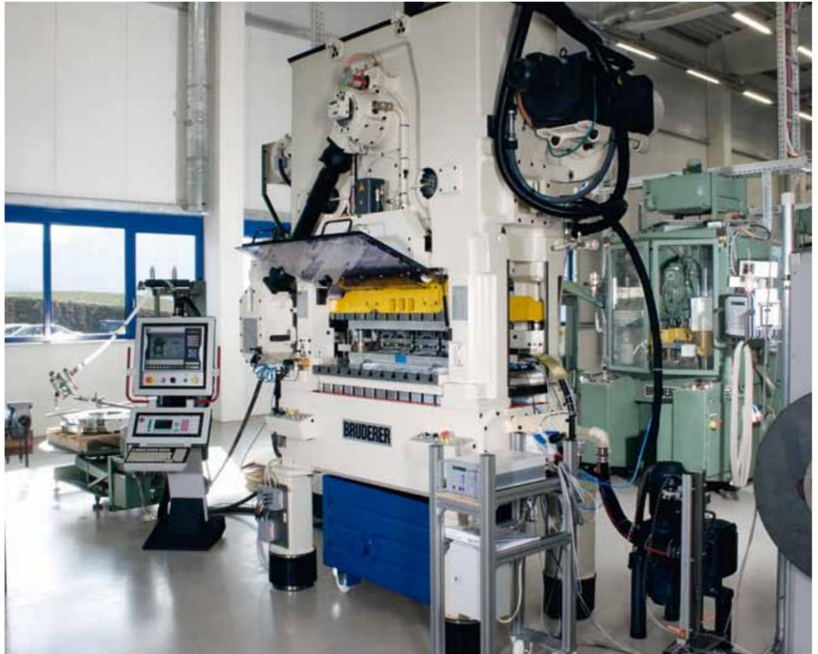
Mehrere Arbeitsgänge in einem Prozess integriert: Bruderer Stanzautomaten bei Unimet.
