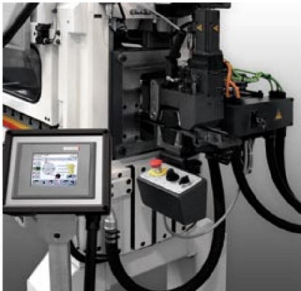
BSV 70 in „stand alone“ Ausführung – montiert an einen Hochleistungs-Stanzautomaten der Baureihe BSTA 300
