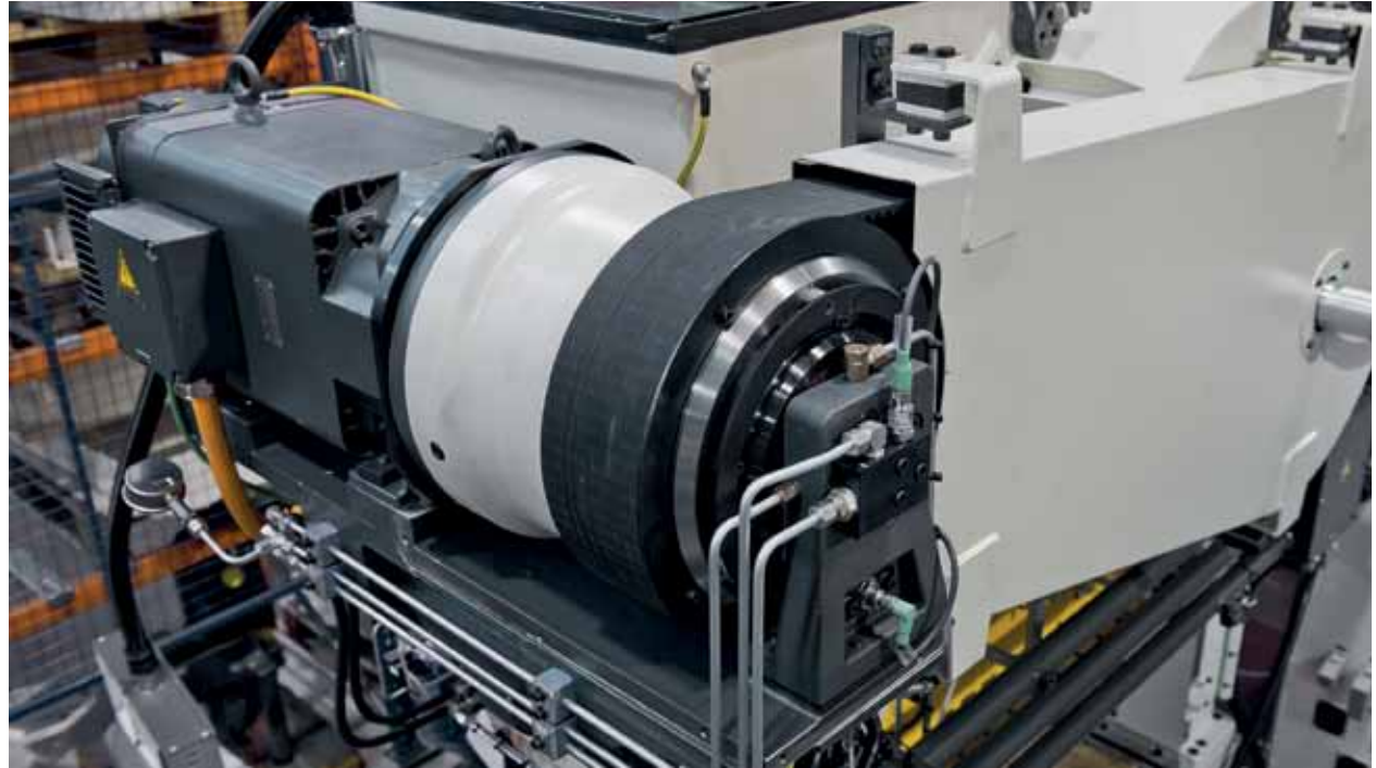
An den Hauptmotor montiertes Planetengetriebe mit allen Anschlussleitungen
