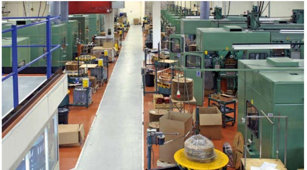
Blick in die Fertigung von Batten & Allen in Cirencester: Auf 24 Hochgeschwindigkeitsstanzautomaten von Bruderer werden überwiegend Werkzeuge aus dem eigenen Werkzeug- und Formenbau eingesetzt. Jeder achte Mitarbeiter übt Prüffunktionen auf Stichprobenbasis aus.
