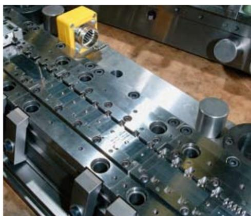
Mehrstufiges Multi-Out-Werkzeug, wie es bei Batten & Allen auf Bruderer-Pressen eingesetzt wird.
