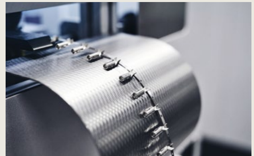
3 e étape Il en résulte des modules complexes produits très efficacement à une cadence pouvant atteindre 600 coups par minute.
