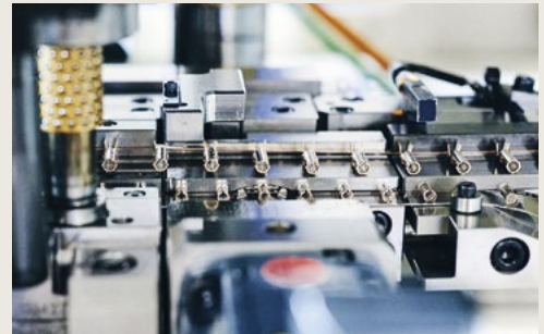
2 e étape Les contacts sont équipés d'un ressort interne directement dans la presse à découper.
