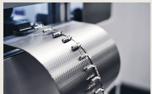
第3步 实现以每分钟高达400次的冲压速度高效生产复杂组件。
