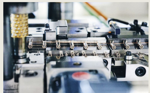
第2步 在冲压中直接将内置弹簧加在插片式连接器上。
