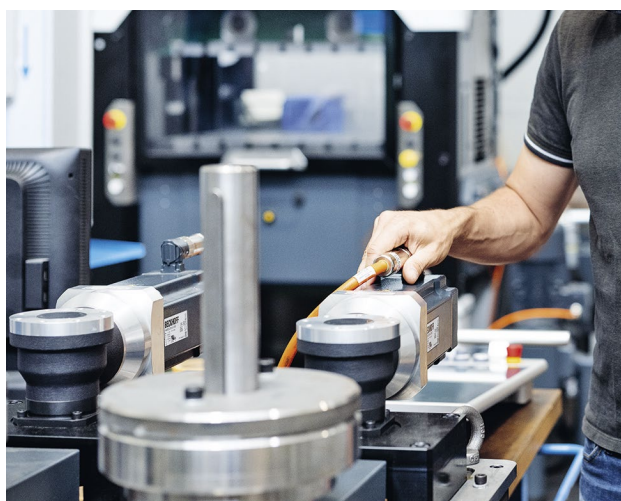
可自由编程的旋转工位 可生产各种形状的铁芯材料。
